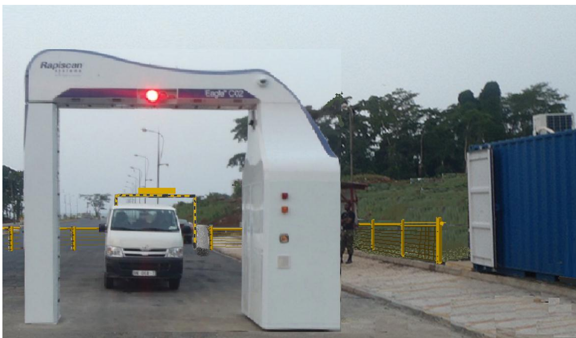
Рисунок 3-1. Eagle C02 с дополнительным пунктом досмотра
