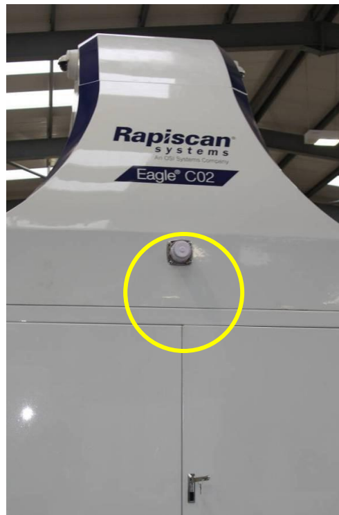
Рисунок 6-6. Звуковой оповещатель, установленный на шкафу с компонентами системы
