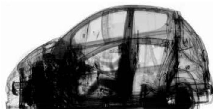
Рисунок 4. Пример изображения в оттенках серого для системы досмотра Eagle C02
