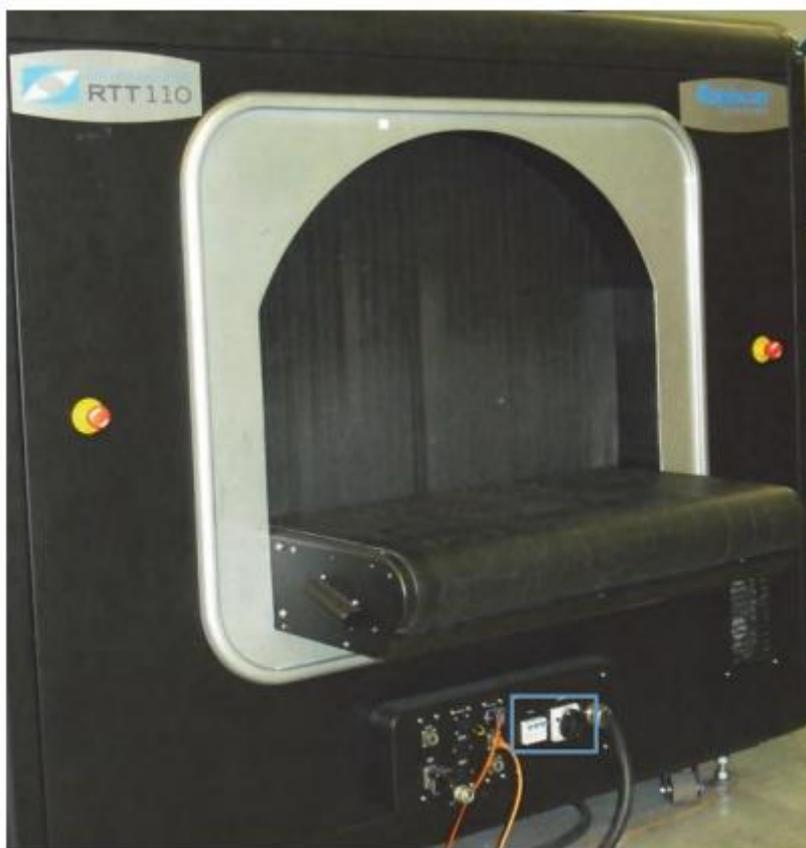
*Рисунок 1 RTT110 - Расположение Главного автоматического выключателя (ГАВ) и Главного сетевого выключателя*
