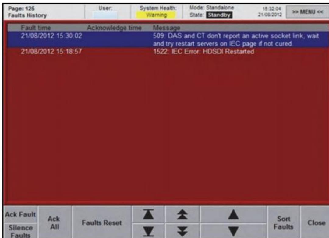
Рисунок 12 АРМ, Панель управления машины, страница История неисправностей
