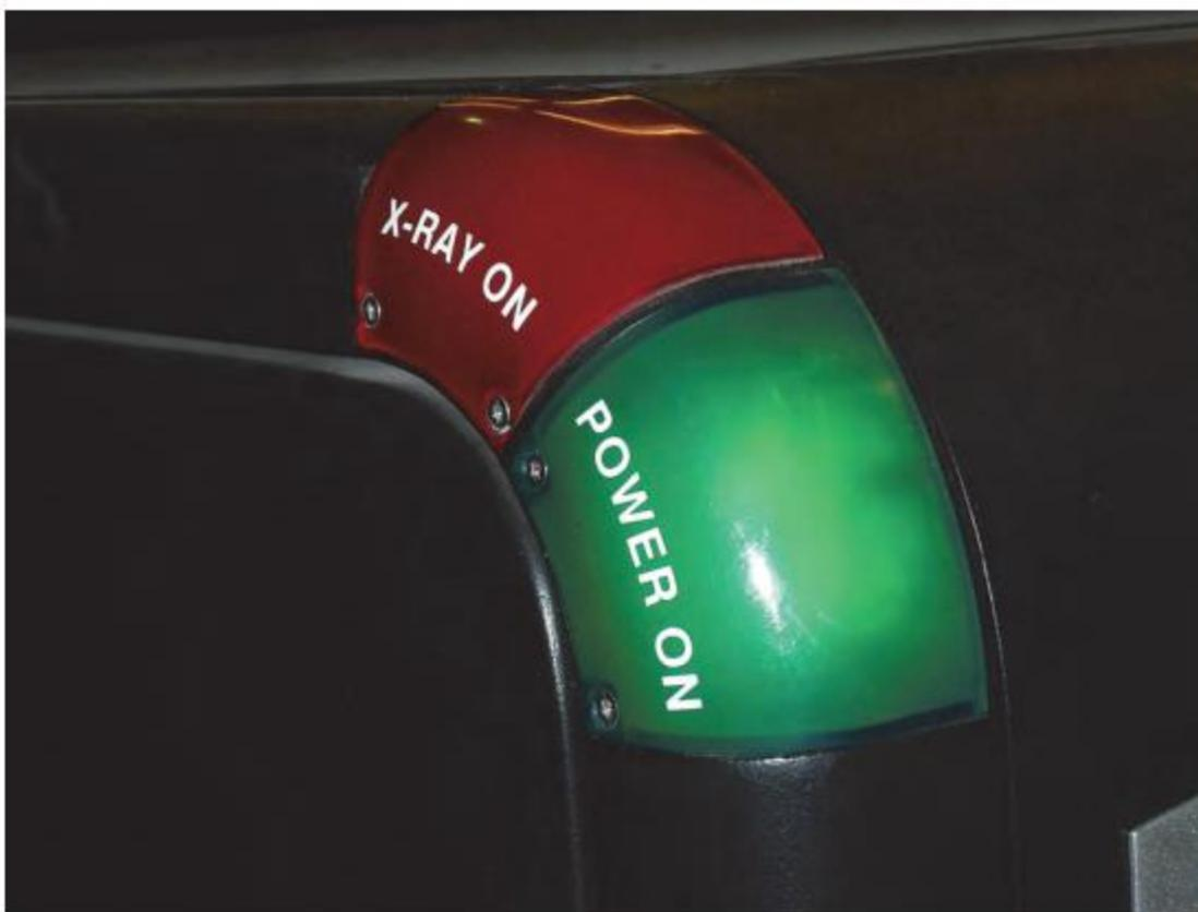
*Рисунок 2 Индикаторы безопасности RTT110, Лампа загорается при включении*
