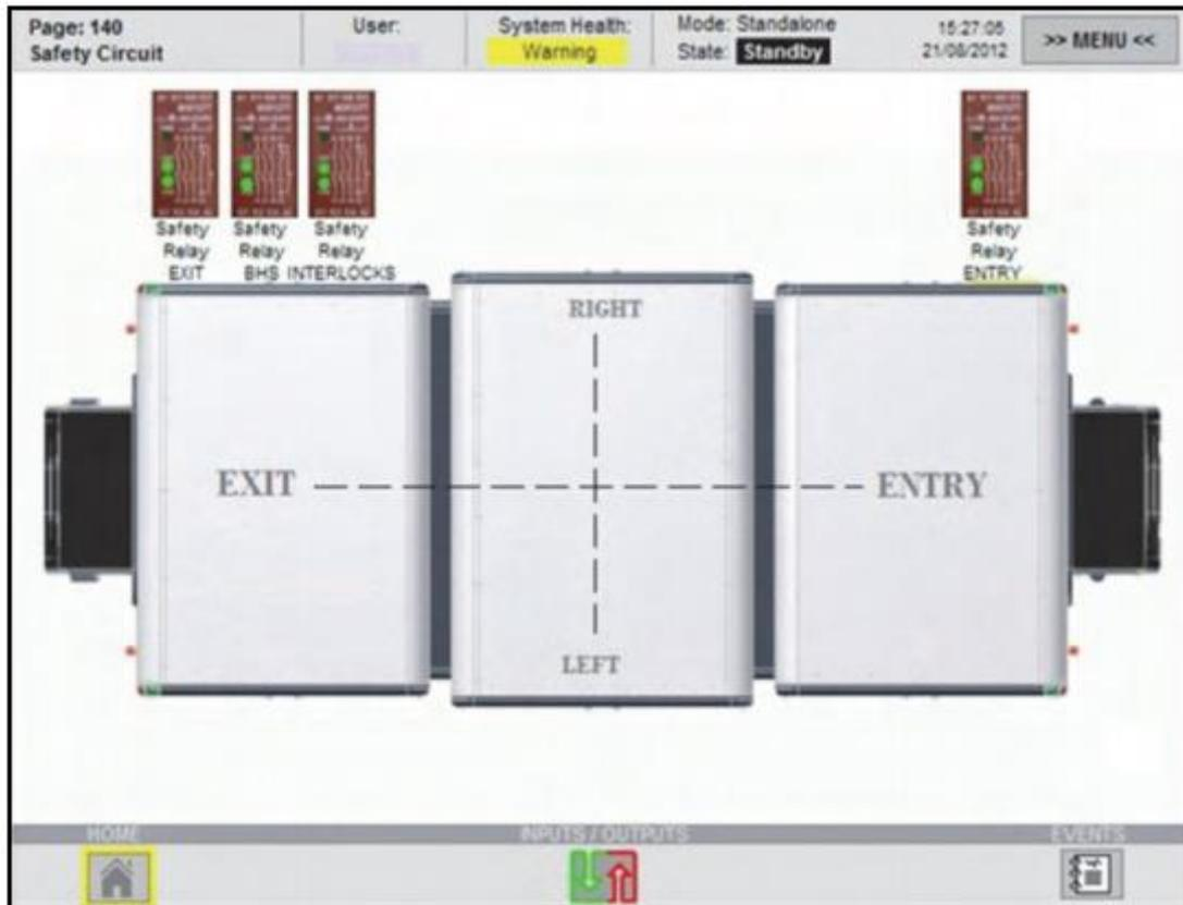
Рисунок 8 АРМ, Панель управления машины, страница цепей защиты
