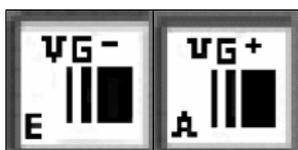
Функция «переменная гамма» позволяет оператору изменять яркость изображения. Использовать для этого кнопки VG+ и VG-.
