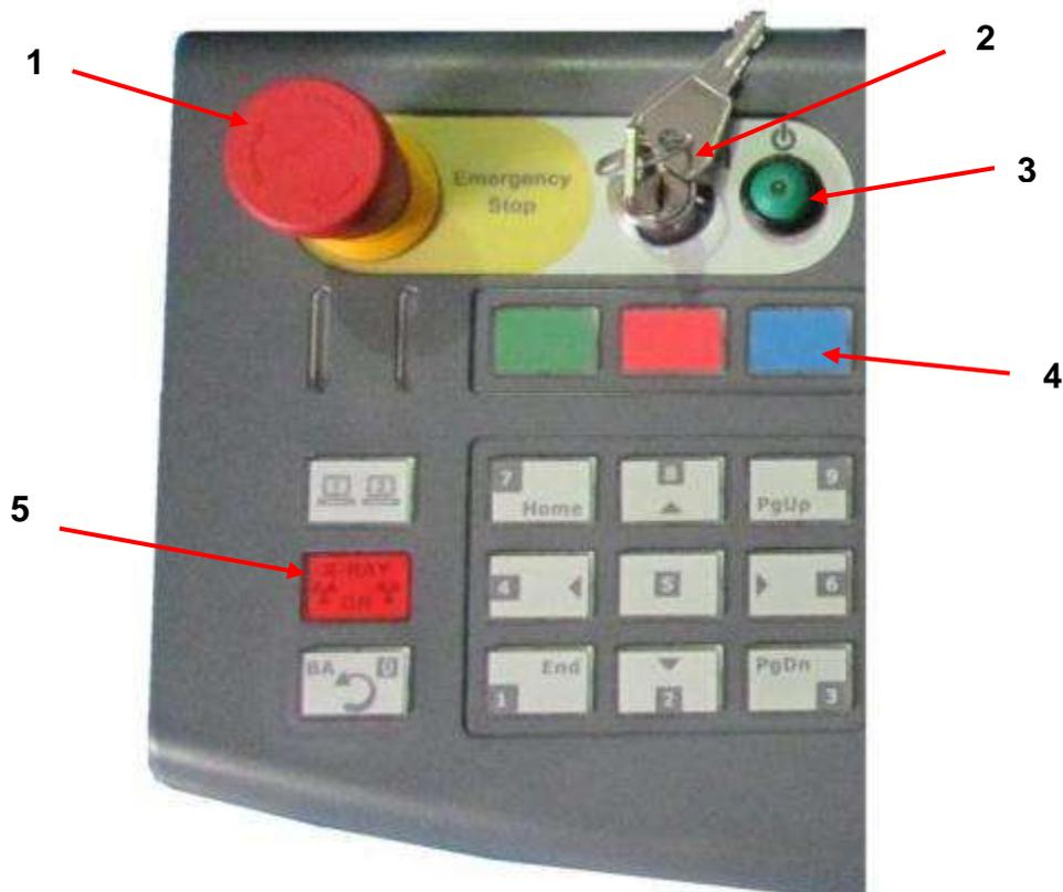
Рисунок 7-5 Кнопка аварийной остановки, Кнопка включения, Индикаторы и клавиатура
