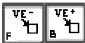
Кнопки переменного усиления кромки (VE- и VE+) делают границы объектов более резкими, что облегчает их рассмотрение. Многократные клики по кнопке VE- или по кнопке VE+ будут либо уменьшать, либо увеличивать резкость различных границ в пределах сканируемых объектов. На рис. показаны изображения с многократным применением кнопок VE+ и VE-
