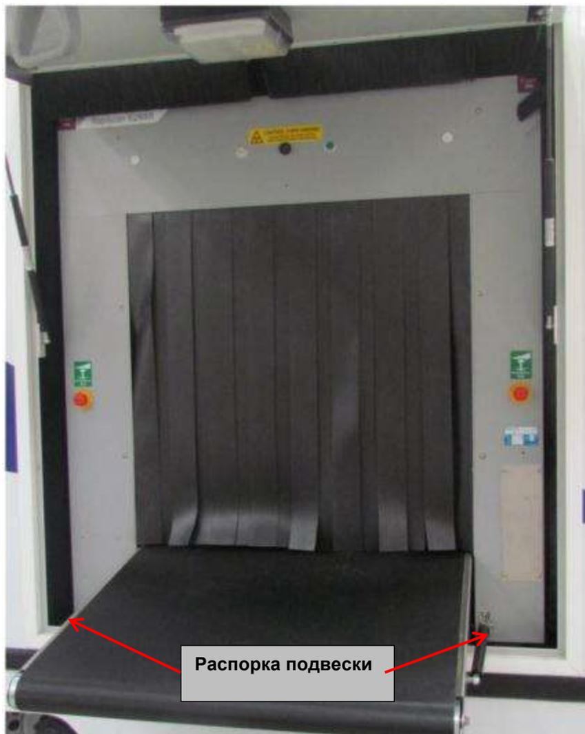
Рисунок 7-2 Роликовый настил в полностью опущенном состоянии
