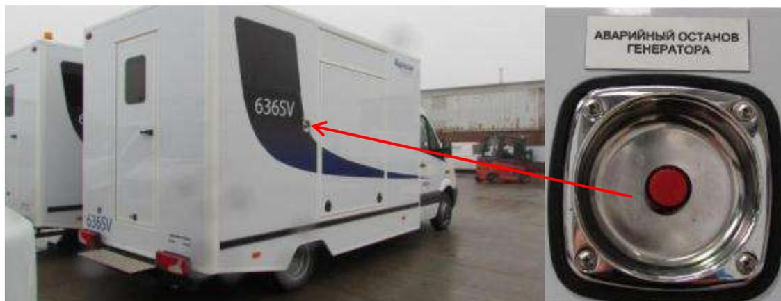
Рисунок 6-3 Кнопка аварийной остановки, установленная на фургоне
