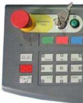
Рисунок 6-2 Панель управления кнопок аварийной остановки 628 (Обычно)
