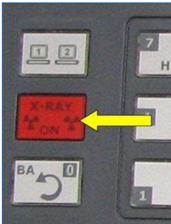
Рисунок 8-4 Лампы включения рентгеновского излучения
