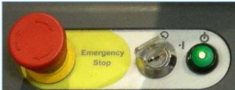
Рисунок 8-33: Кнопка аварийной остановки, замок с ключом и кнопка питания
