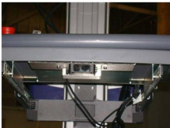
Рисунок 3-3: Датчик присутствия оператора на стойке оператора
