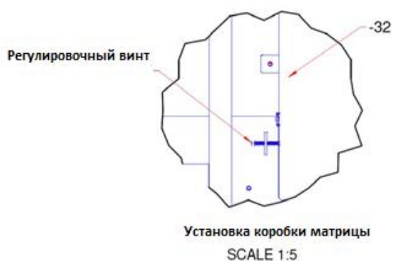
Рисунок 25-7: Регулировочная метка диодной матрицы 628DV -- Вертикального (“сверху”) вида
