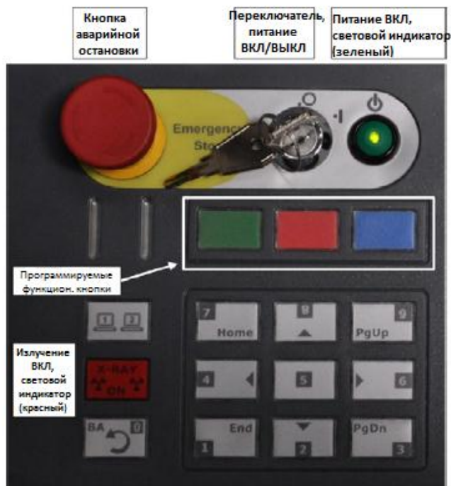
Рисунок 2-12: ПУО: Кнопка аварийной остановки, Переключатель, Питание ВКЛ, Сенсорная панель, Навигационные клавиши
