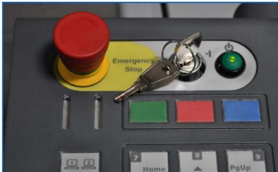
Рисунок 11-3: Контрольный переключатель и Индикатор "Питание включено" на ПУО
