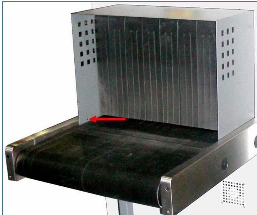
Рисунок 26-16: Болты, соединяющие кожух конвейера и боковую направляющую
