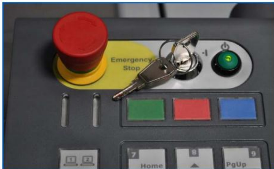
Рисунок 13-3: Контрольный переключатель и Индикатор "Питание включено" на ПУО
