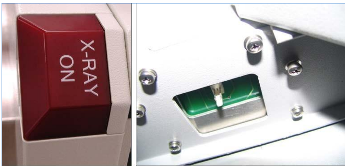
Рисунок 29-6: Индикатор Рентгеновское излучение включено, Лицевая сторона и задняя часть
