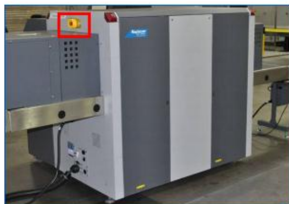
Рисунок 6-2: Кнопка аварийной остановки на каждой из Областей Шкафа Сканера 620 DV
