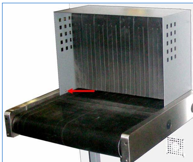
Рисунок 26-5: Болты, соединяющие кожух конвейера и боковую направляющую
