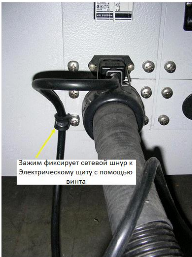
Рисунок 10-14: Зажим фиксирует сетевой шнур к Щиту
