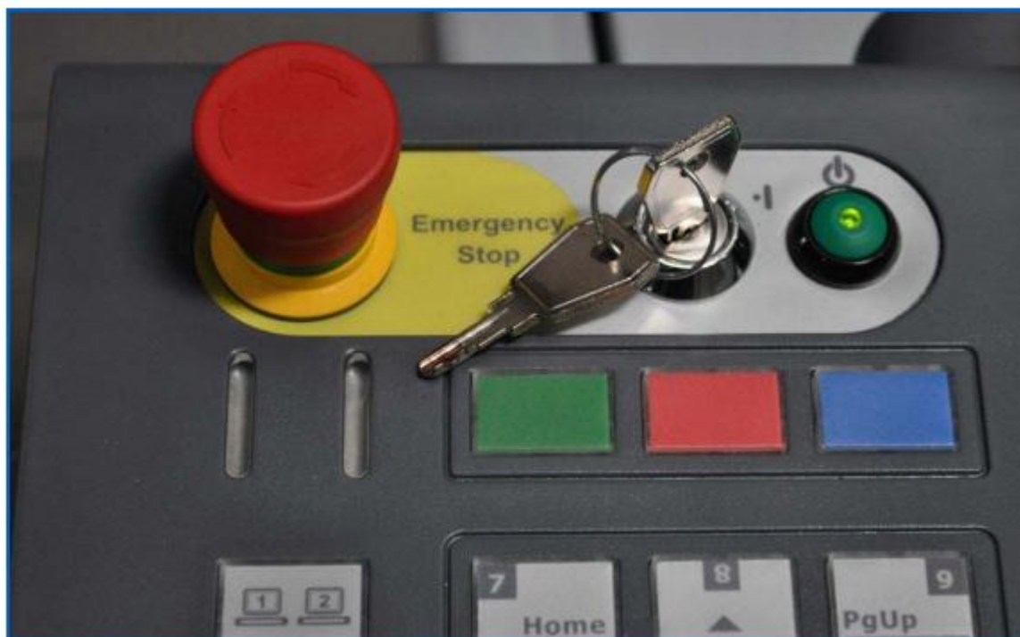
Рисунок 6-1: ПУО: Контрольный переключатель и Кнопка аварийной остановки
