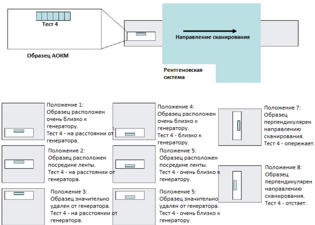
Рисунок 11-10: АОКМ F792-08 Диаграмма расположения образца (Вертикальный вид)
