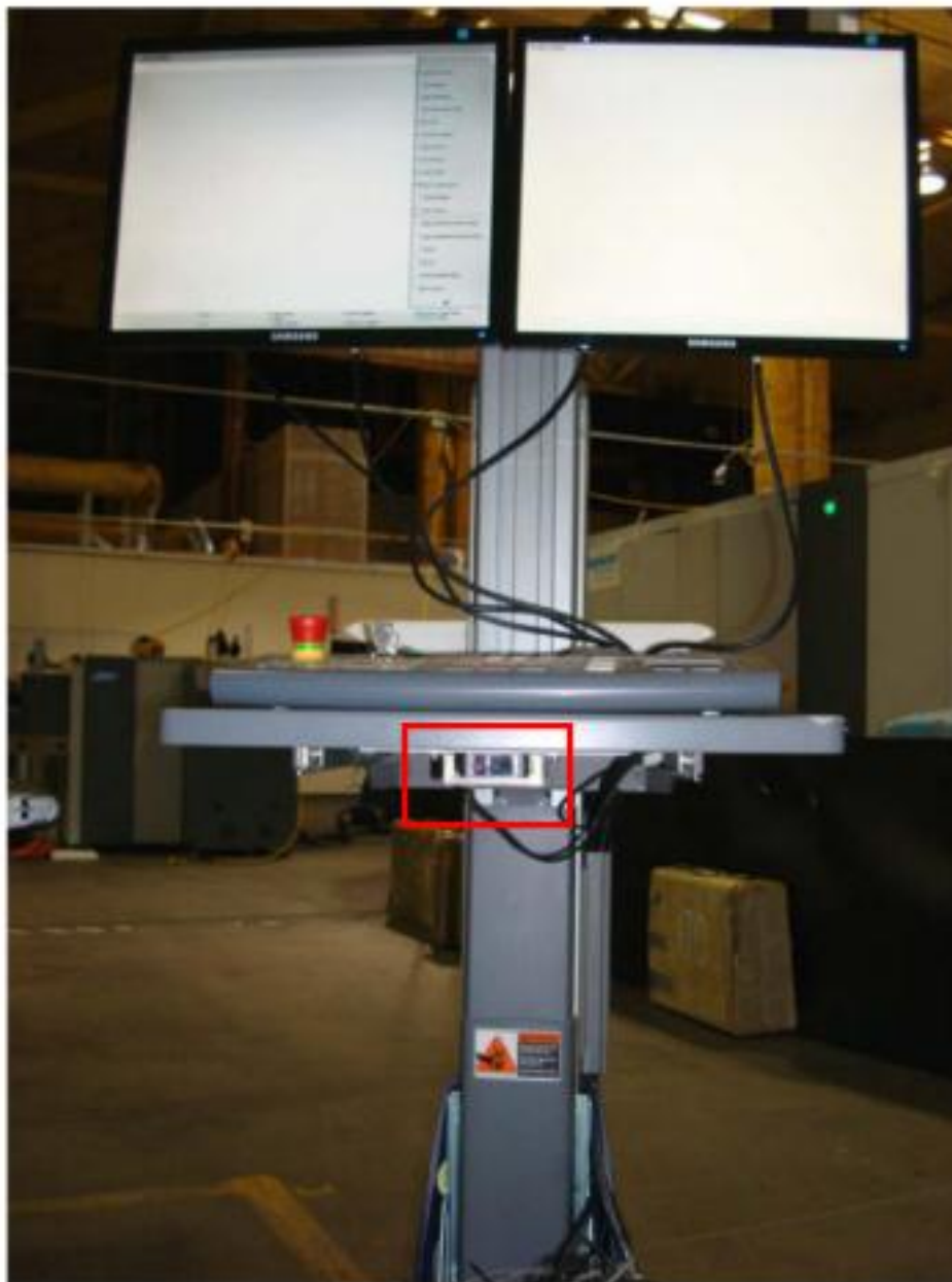
Рисунок 6-10: Датчик присутствия оператора на стойке оператора
