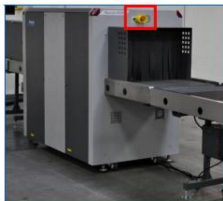
Рисунок 6-2: Кнопка аварийной остановки на каждой из Областей Шкафа Сканера 620 DV
