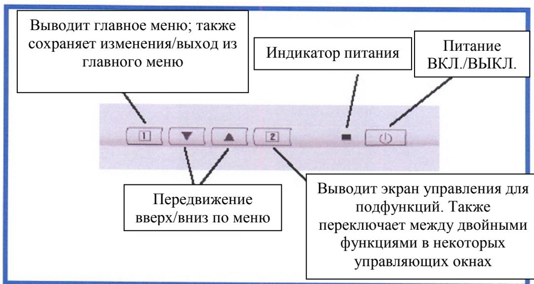
Рис.3-11: Управление монитора
