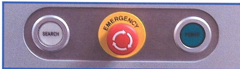
Рис.3-10: Лампы «Search» и включения питания и аварийный выключатель
