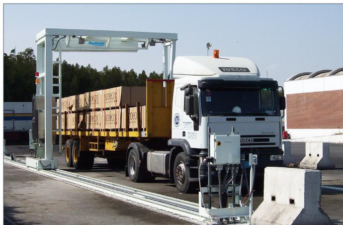
Козловая установка Rapiscan GaRDS™ Gantry (гамма-лучевая система досмотра) – рентабельная, безопасная и надежная система досмотра грузовиков, транспортных средств и грузовых контейнеров с целью выявления запрещенных предметов, незадекларированных товаров и проверки грузовой декларации. Rapiscan GaRDS Gantry поставляется в двух модификациях: с повышенной и стандартной проникающей способностью.
