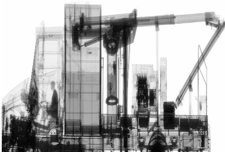
Рис. 4. Полученное системой Eagle T10 изображение мобильного сканера Rapiscan
