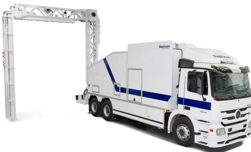
Рис. 2. Система Eagle M60 в развернутом виде
