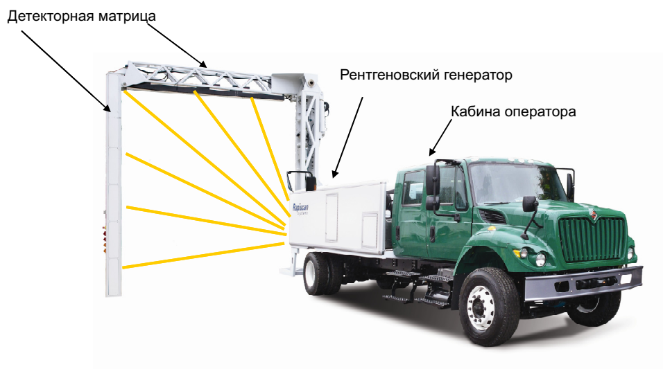
Рис. 3. Рентгеновская система досмотра Eagle M10
