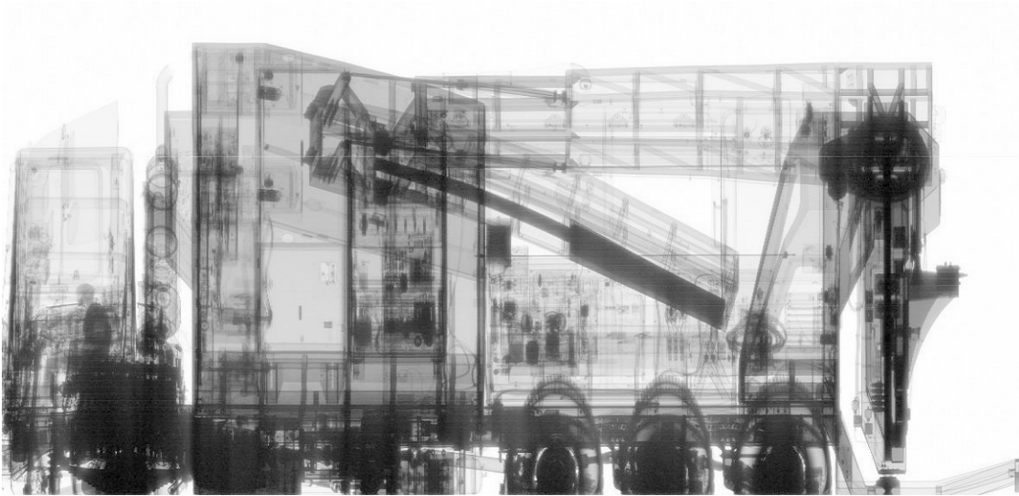
Рис. 4. Полученное системой Eagle M10 изображение мобильного сканера Rapiscan
