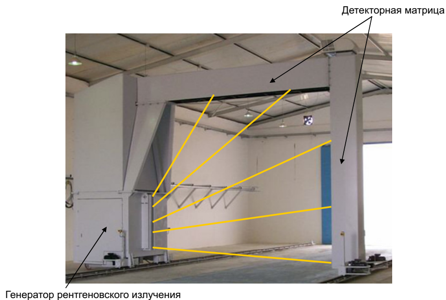
Рис. 2. Рентгеновская система досмотра Eagle G60
