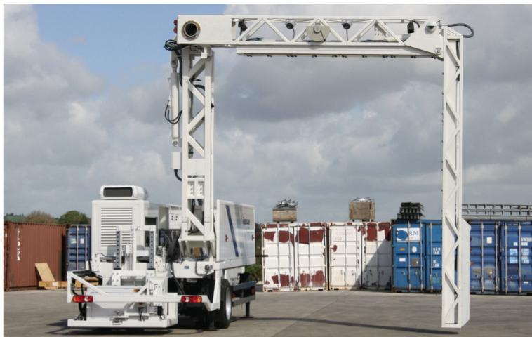
Коммерческая конфигурация модели Eagle® T10, развернутая в порту для сканирования перемещающегося транспорта.
