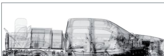
Безопасное сканирование 100% груза с помощью высокоэнергетического рентгеновского излучения.
