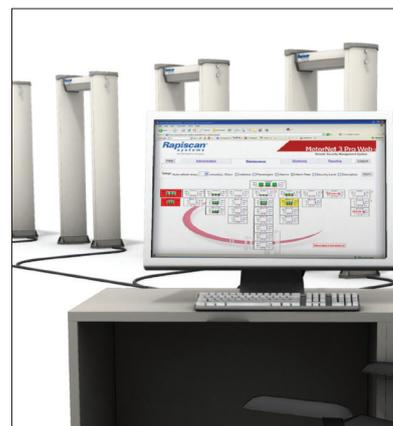
MetorNet 3 Pro Web — дистанционная система управления безопасностью на базе Windows, позволяющая вывести на экран всю информацию по металлодетекторам. Система обеспечивает мониторинг сведений о пассажирах, сбор и обработку данных пассажиров универсальными инструментами отчетности, а также управление и контроль за всеми параметрами проходных металлодетекторов Metor.
