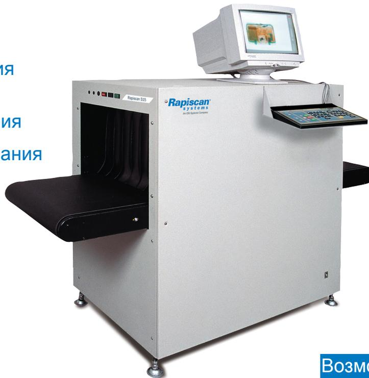
**Rapiscan 515** – компактная двухэнергетическая рентгеновская система, которая идеально подходит для установки в местах с ограниченной площадью. Двухэнергетическое построение изображения обеспечивает автоматическое присвоение цветов материалам с разным атомным числом, что позволяет операторам легко идентифицировать предметы внутри посылки. Система оснащена съемной панелью управления, что способствует повышению ее мобильности.
