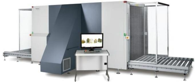
Модель Rapiscan 638XR представляет собой систему рентгеновского сканирования для устройства комплектования грузов (ULD), согласно стандарту ISO для досмотра нижней палубы и крупногабаритных грузов на поддонах. Устройство обладает туннельным окном с размерами 1837 мм x 1800 мм и использует инновационную технологию для автоматического определения взрывоопасных и наркотических веществ, обеспечивая высококачественными изображениями сканируемого объекта во время досмотра.
