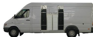
Монитор TSA MD134 в разрезе, установленный в автомобиле для мобильного досмотра. (Автомобиль не входит в комплект.)
