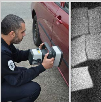
СЛЕВА: Досмотр двери пассажирского транспортного средства с помощью MINI Z СПРАВА: Изображение со скрытой валютой
